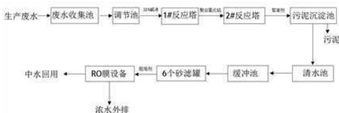
图 2.2-1 现有工程污水处理站工艺流程
